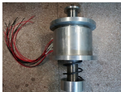
图1圆筒式直线发电机
