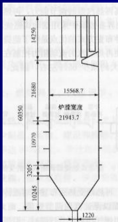
图 11-7 600MW 锅炉炉型 III
