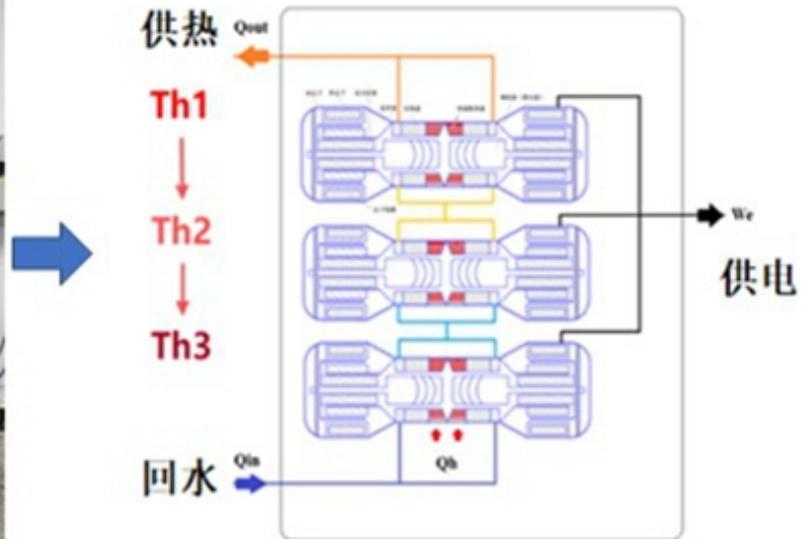
图2 多级变温余热自由活塞热声发电供热系统（自由活塞型）
