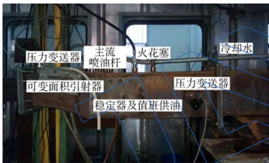
图 2 TBCC 超级燃烧室试验模型
