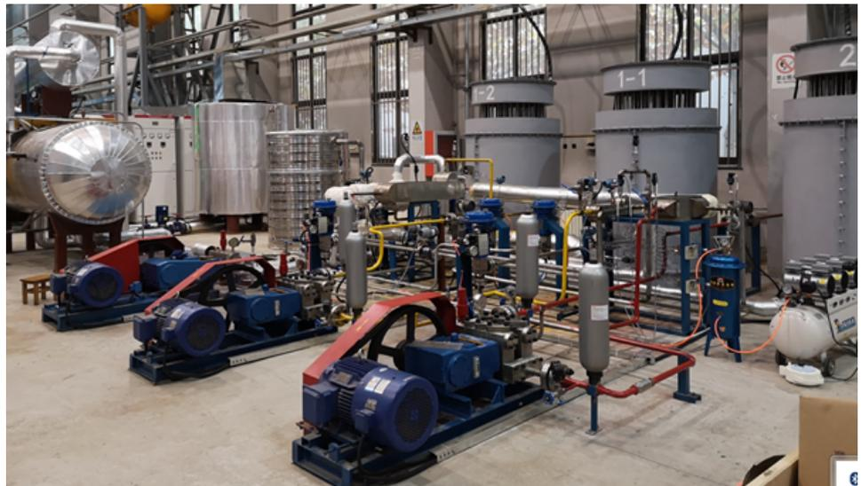
图1 超临界CO<sub>2</sub>换热器测试平台
