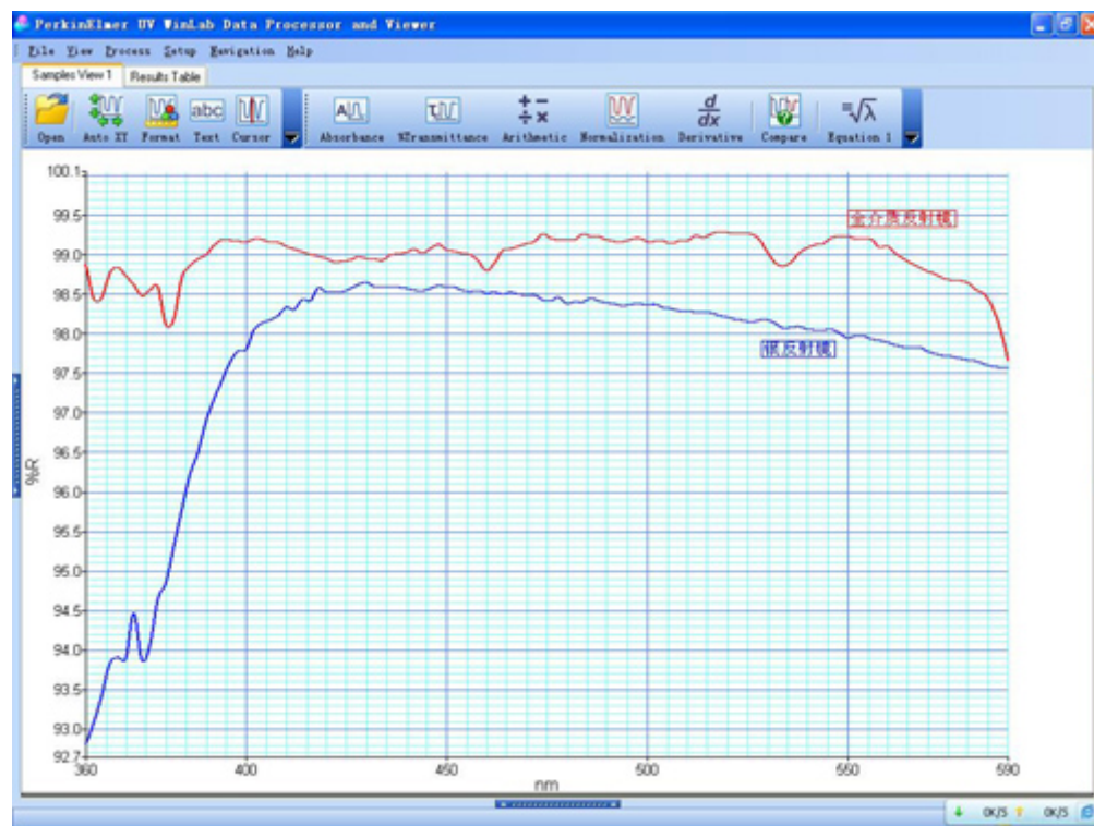
与以往采用镀银蓝区反射镜的反射效率比较
