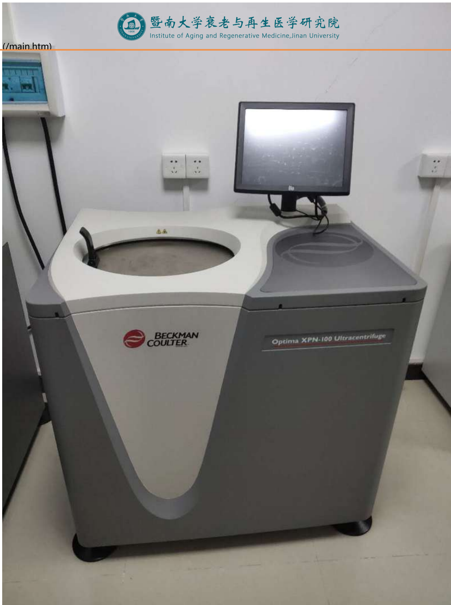
型号及品牌: Beckman公司; 仪器介绍: 用于病毒、密度梯度离心等分析分离样品 放置地点: 第二理工楼849; 管理员: 刁道君
