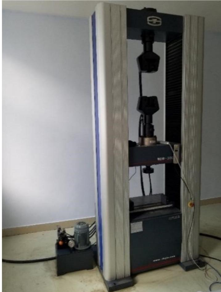
中文名称: 300kN电子万能试验机
