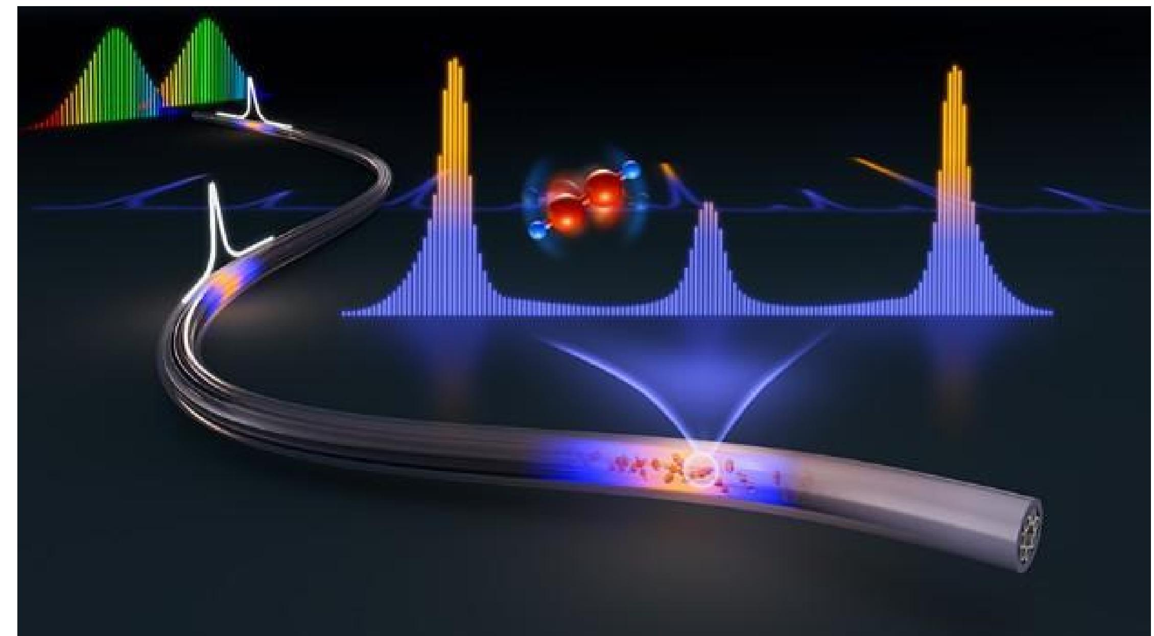
当两个具有相干性的频率梳(左上角)发出的光束同时通过载有气体样本的空心光纤时，每一对频率梳齿会在光纤中产生拍频信号，气体吸收会引起光热效应，改变气体折射率。图片来源：香港中文大学
