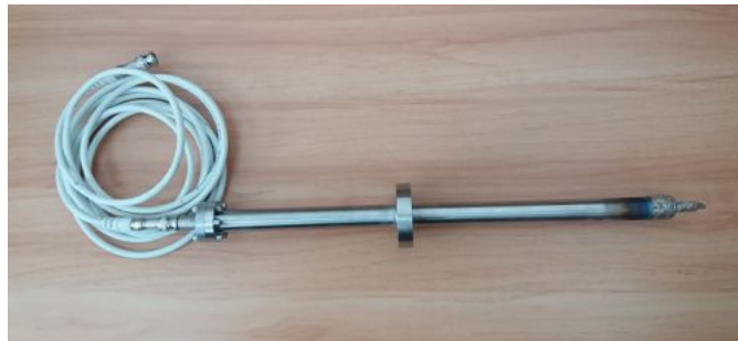
图1：自主研制的Bi-Bi 2 O 3 型氧传感器
