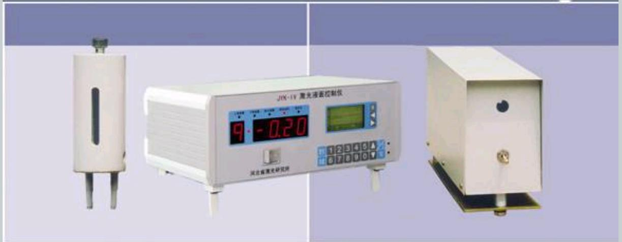
JYK-IV激光液面控制仪是JYK-III激光液面控制仪的升级产品。该仪器是窑炉熔融玻璃液位测量及控制的专用仪器。其测量分辨率高、液位控制波动小、操作简便、稳定可靠。该仪器具有数字显示液位相对高度、液晶实时显示液位变化曲线、手动自动切换、断续及连续加料输出、上下限报警指示、断光指示及自我检测等多种功能，为玻璃行业理想的液位检测及控制仪器。
