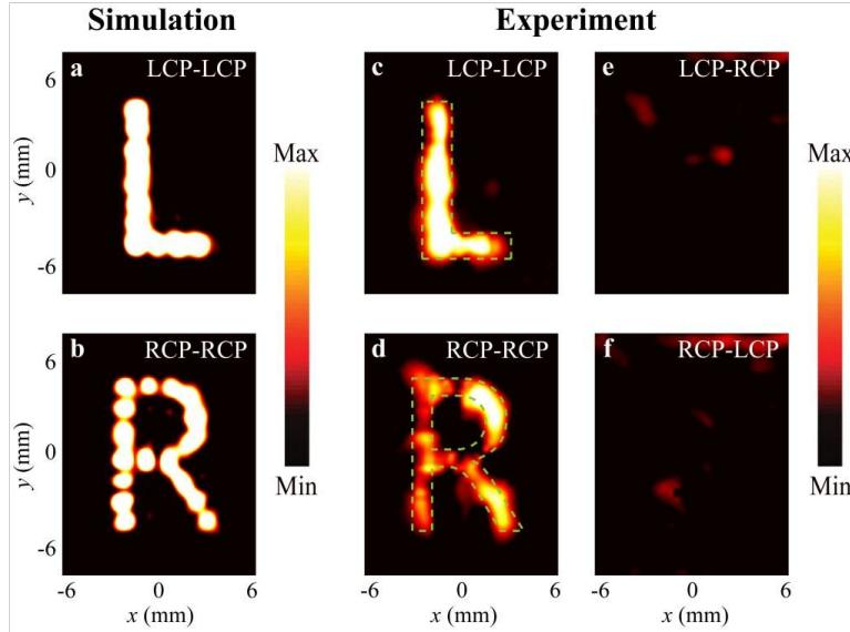
“全息成像的关键步骤是要将光投射到全息板上，而我们的研究成果让全息板变得‘更聪明’！”据天津大学太赫兹研究中心韩家广教授介绍，目前主流全息成像技术所使用的全息板不能辨别光的偏振态，难以做到独立成像。而天津大学科研团队发现，经过精密设计的超表面对太赫兹波能够产生强烈的“手性响应”，使用这种超表面材料制成的全息板可以识别不同光的偏振态，记忆信息量也更丰富，让全息板“变聪明”，最终实现完全独立的全息成像，大幅度提高了全息板工作效率。
