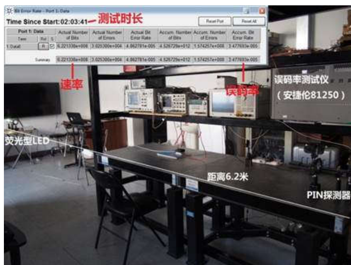
半导体所基于荧光型白光LED实现610Mbps单路实时传输
