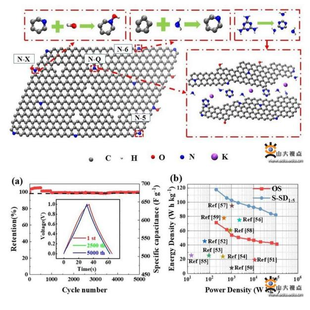
针对上述问题,在韩奎华教授的指导下,课题组采用植物薄壁组织、维管组织材料为原料,炭化后将KOH和三聚氰胺混合浸渍,高温活化造孔和氮掺杂协同实现,多孔炭比表面积为2642m²/g,采用6M KOH电解液制备的双电极扣式电容,电化学测试表明,当电流密度为1A/g时,比电容从364F/g增加到715F/g,并显示出良好的倍率性能(526F/g在100A/g时)和循环性能(在5A/g下5000次循环后98.28%的电容保持率)。当功率密度为200W/kg时,能量密度达到118Wh/kg。高比电容主要来源于电双层电容,与传统的表面掺杂相比具有明显的优势。氮原子稳定地嵌在碳骨架中,N-Q官能团对比电容和循环性能均有明显改善作用。因此,该工作为不同用途的高性能氮掺杂多孔炭设计和制备提供了新的方法和指导。
