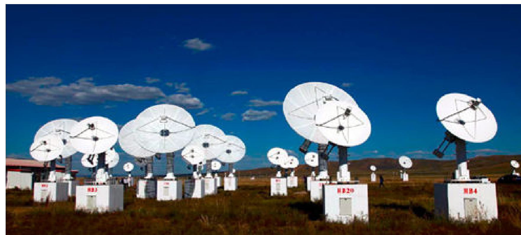
明安图射电频谱日像仪 (MUSER) 中心部分天线观测太阳时状态。
