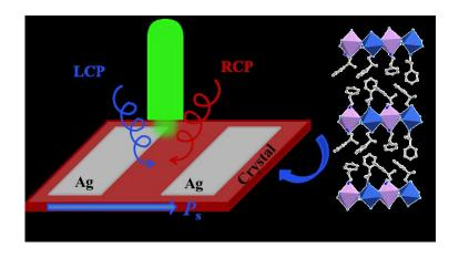
圆偏振光探测在量子通信、自旋光学信息等领域具有广泛应用。传统圆偏振光探测需非手性光电探测材料和外加光学元件(线偏振片和四分之一玻片等)。以上器件结构难以满足日益需求的集成微型化应用。近几年发展的有机--无机杂化手性钙钛矿兼具手性和半导体光电特性,无需外加光学元件便可实现对圆偏振光的响应。
