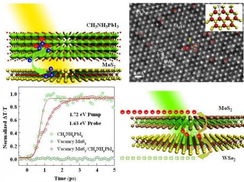
界面电荷转移是光电器件领域中的核心科学问题。彭波教授开展了单层MoS<sub>2</sub>中S原子空穴设计与调控的研究，突破了pristine MoS<sub>2</sub>/CH<sub>3</sub>NH<sub>3</sub>PbI<sub>3</sub>Type I型异质结的限制，实现了CH<sub>3</sub>NH<sub>3</sub>PbI<sub>3</sub>中的空穴向单层MoS<sub>2</sub>超快高效转移（320 fs, 83%），达到国际先进水平（spiro-OMeTAD, 86%）。在超薄、高效、柔性光电器件领域具有广阔的应用前景。该工作发表在《ACS Nano》-Achieving Ultrafast Hole Transfer at the Monolayer MoS<sub>2</sub> and CH<sub>3</sub>NH<sub>3</sub>PbI<sub>3</sub> Interface by Defect Engineering, DOI: 10.1021/acsnano.6b02845, 2016 (In press)。
