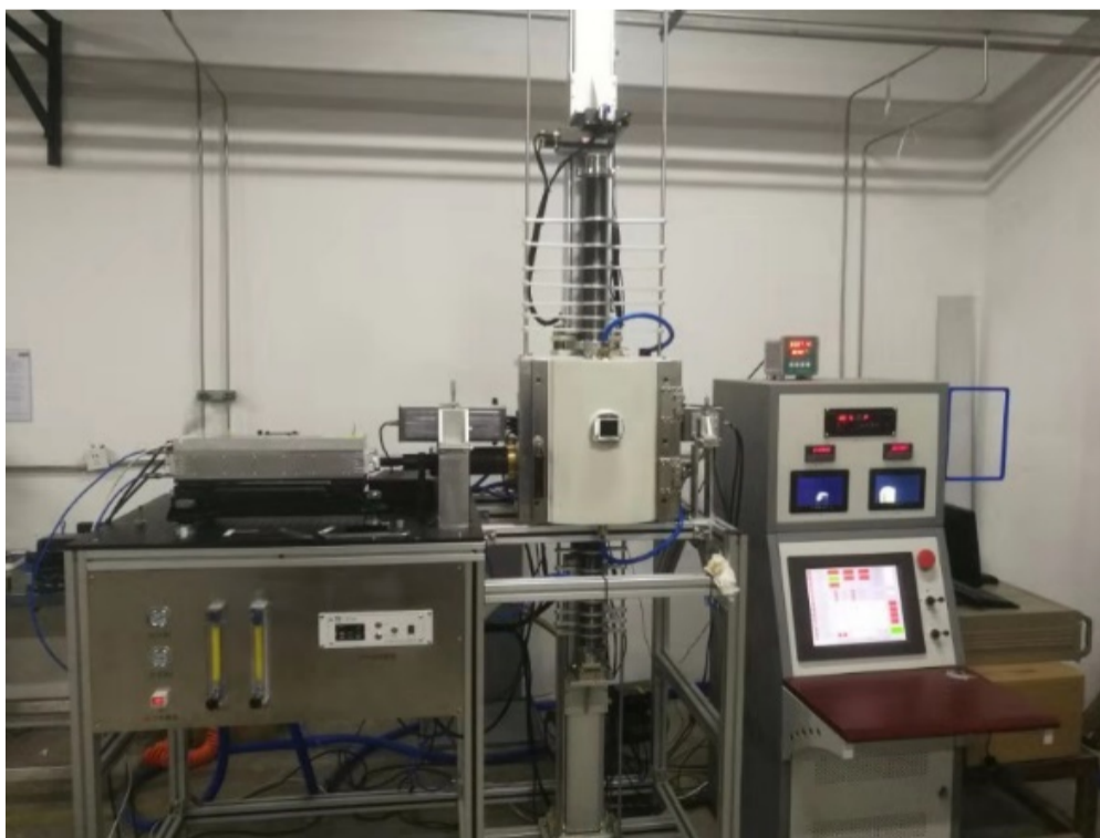
自主研制的激光加热基座(LHPG)单晶光纤生长炉
