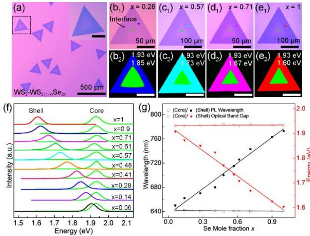
现阶段二维异质结的合成方法主要有一步合成法和多步合成法。由于合金在热力学上是能量更低,利用一步法合成的异质结很难形成原子级别陡峭的界面。多步法合成的异质结虽然可以实现原子级别陡峭的界面,然而,其操作复杂,在可重复性和可控制性上依然是一个不小的挑战。近年来,潘教授团队在二维材料能带调控工程以及异质结可控合成方面做了大量的系统研究,积累了丰富的研究经验。在本工作中,郑弼元等巧妙地利用双温区和双气路的实验设计,通过系统的精确调控,成功实现了界面能带排列连续可调的二维半导体平面异质结WS<sub>2</sub>-WS<sub>2</sub>(1-x)Se<sub>2x</sub>的可控制备,所得到的异质结具有高结晶质量及原子级陡峭的界面。高质量能带可调二维半导体异质结的成功制备,为二维原子晶体材料在新型集成光电器件上的广泛应用奠定了基础。
