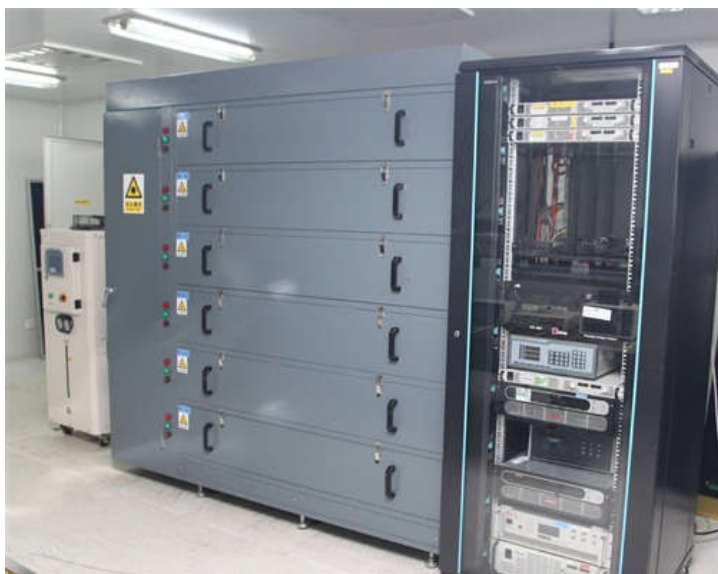
西安光机所研制成功国内首台多功能高功率半导体激光器老化和寿命测试系统
