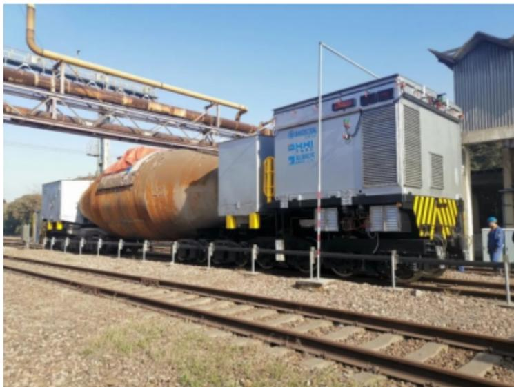
1月15日，由大连重工研制的335吨自行式电驱无人混铁水车现场调试成功。铁水运输是铁钢界的核心要素之一，也是钢铁制造中最重要的物流环节。为了进一步提升运行效率，同时满足智能、绿色的时代发展要求，中国宝武集团联合大连重工等单位共同组建项目团队，通过绿色驱动、智能感知、数字轨道等技术共同推进自行式电驱动无人混铁水车的研发。
