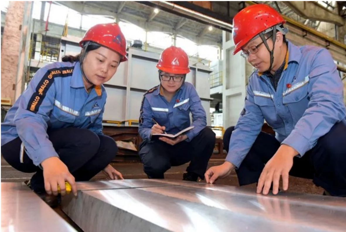
西南铝技术人员在测量C919飞机用模锻件
