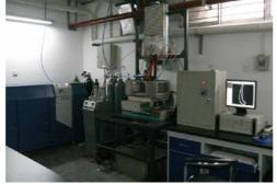
中文名称: 激光金属直接成型试验机
