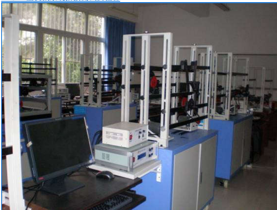
PCC-II型机构运动创新方案设计及参数可视化分析实验台
