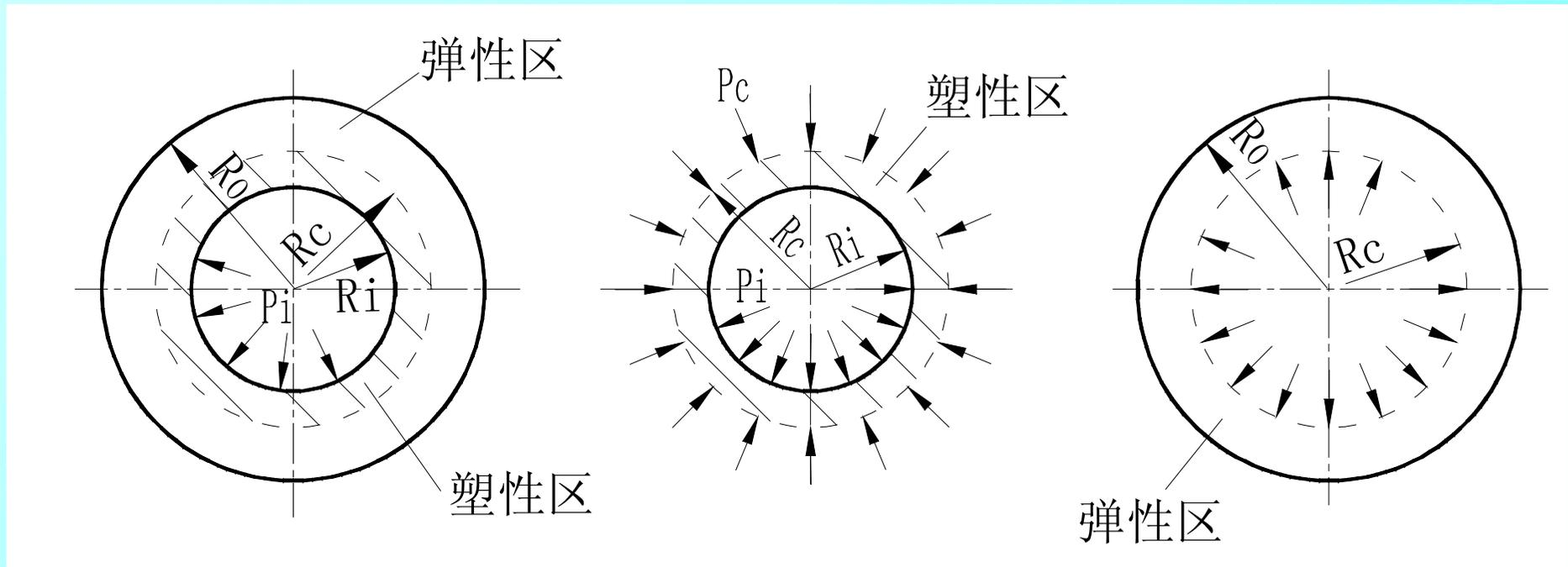
图2-22 处于弹塑性状态的厚壁圆筒
