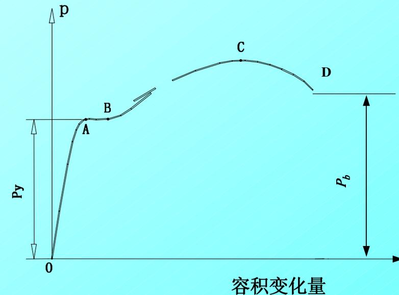
图2-26 厚壁圆筒中压力
