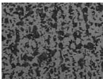
图3 20CrMnTiH 齿轮钢金相组织 ×100
