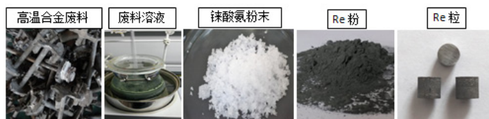
图3 从高温合金废料中回收贵金属Re的主要过程
