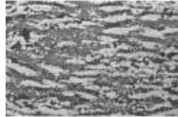
图7 改进后120 mm厚钢板中心处金相组织 100×
