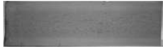
图6 改进后120 mm厚钢板中心处热酸浸低倍组织
