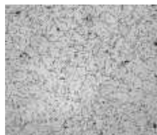
图7 筒体材料的金相组织 100×
