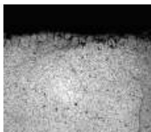
图4 皮下气孔附近的沿晶裂纹 100×
