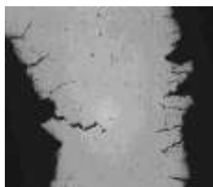
图5 皮下气孔间的沿晶裂纹形态 100×
