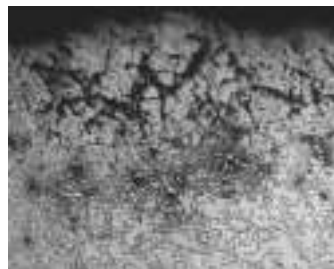
图3 剥落坑附近的晶间裂纹 200×
