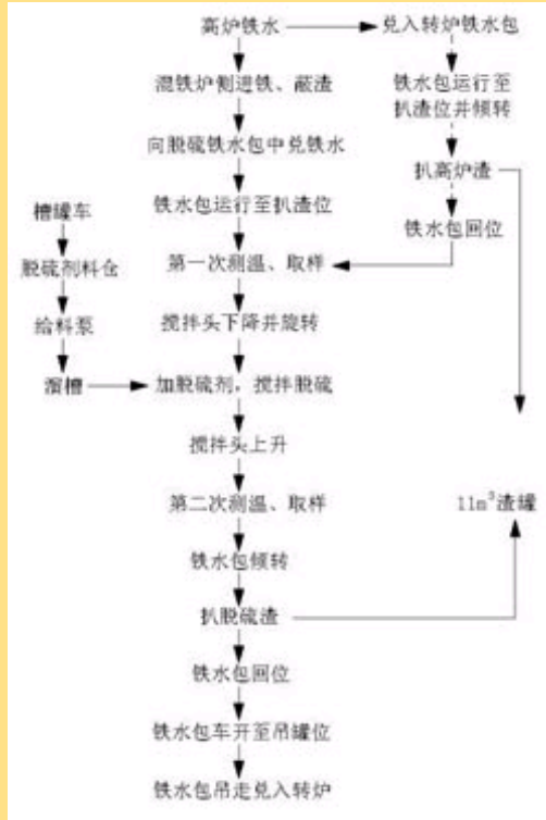
图1 铁水预处理工艺流程
