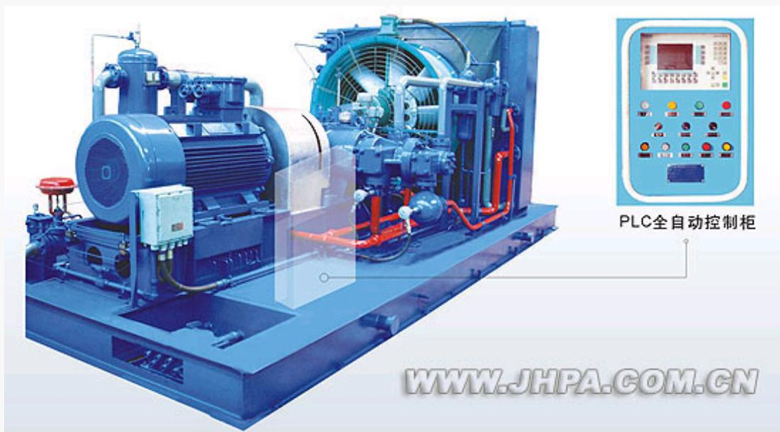
该型压缩机为对称平衡式两列四级压缩，电机直联驱动，采用电子软启动装置，可视化智能控制。有风冷和水冷两种结构供用户选择。曲轴连杆采用独立润滑系统，可同时满足机组的预润滑。气缸采用流量分配器强制润滑，精确调整供油量。机组设置各级排气缓冲罐、过滤分离器、自动排污及卸载回收系统。该型压缩机是专为常规加气站设计的一种大排量机型。
