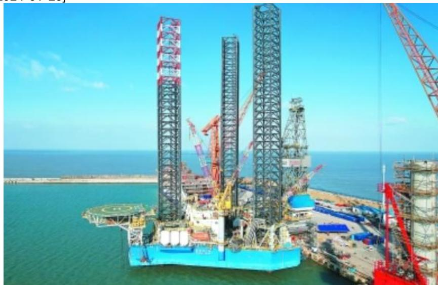
1月22日，胜利石油工程公司新胜利三号钻井平台正式竣工交付。该平台最大作业水深106.7米，最大钻井深度9000米。近年来，胜利油田海上勘探开发力度不断加大，对海上钻井施工提出了更高要求。该平台投用后将有力促进胜利油田海上勘探开发。图为新胜利三号钻井平台。
