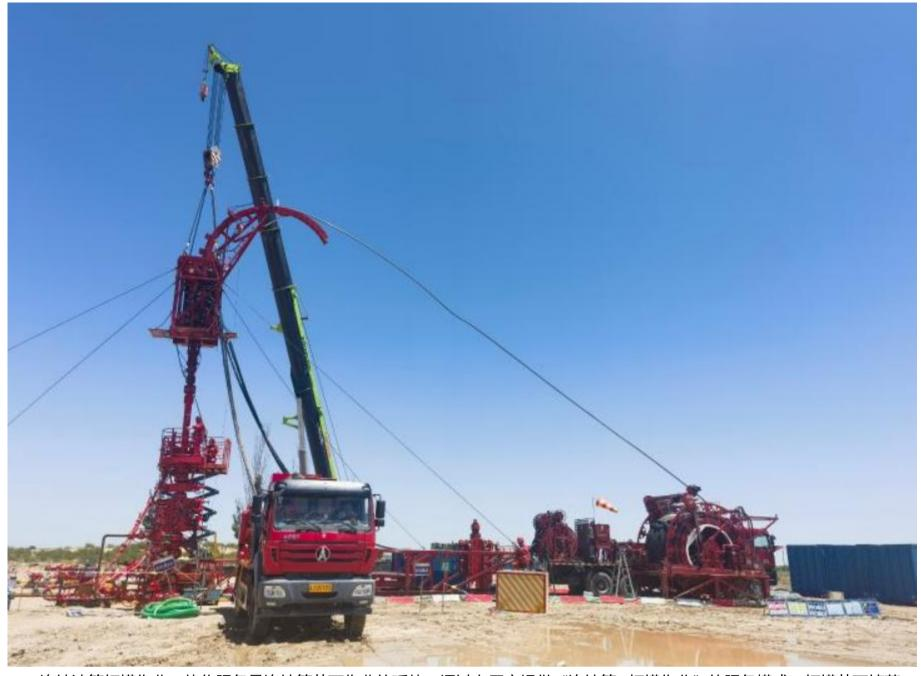
连续油管打捞作业一体化服务是连续管井下作业的延伸,通过向用户提供"连续管+打捞作业"的服务模式,打捞井下掉落的工具串,确保井筒通畅性,为客户解决井筒受阻无法跟进后续作业措施的实际问题。
