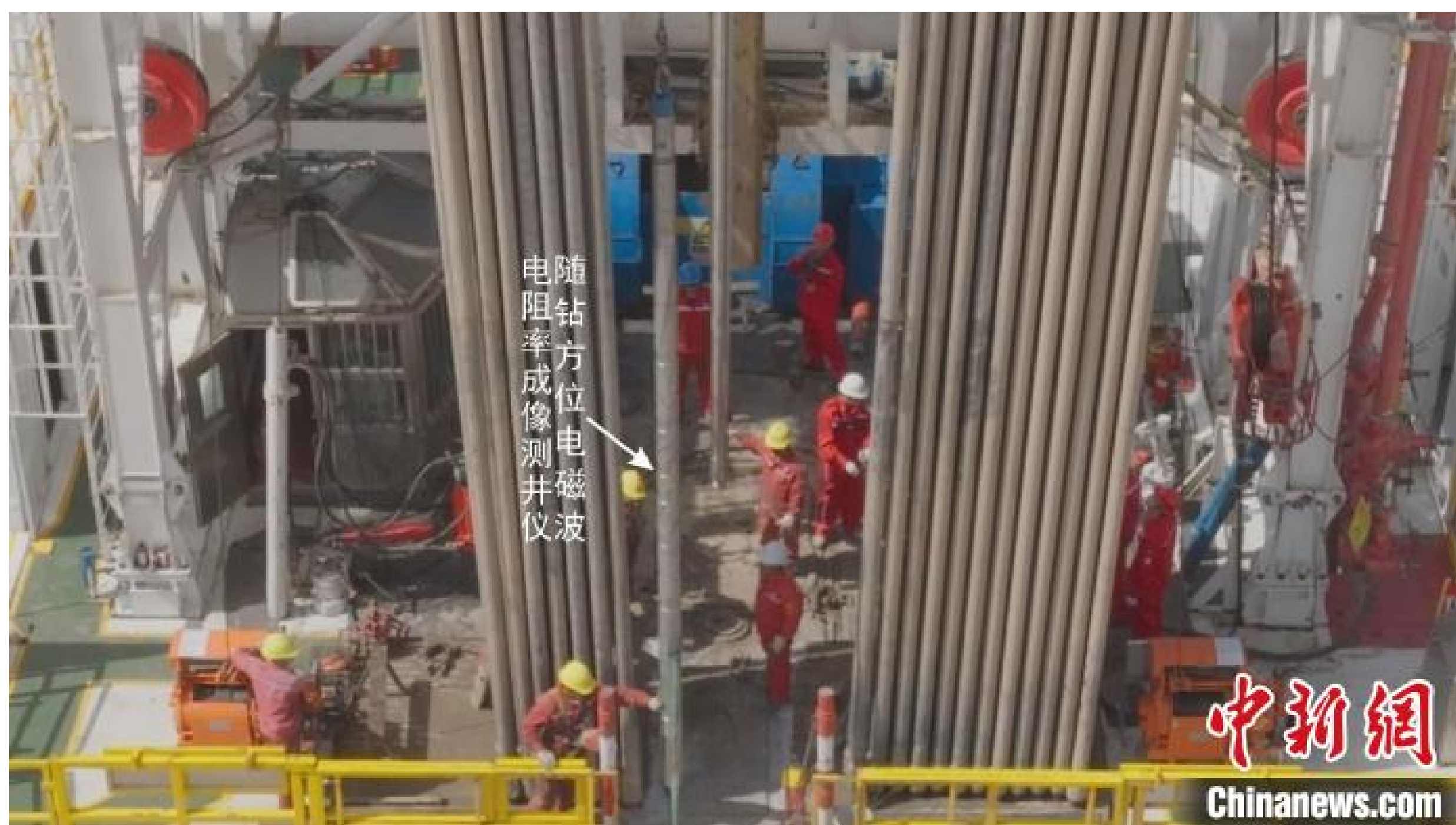
“智能导钻”随钻方位电磁波电阻率成像测井仪入井照片。“智能导钻”专项团队供图
