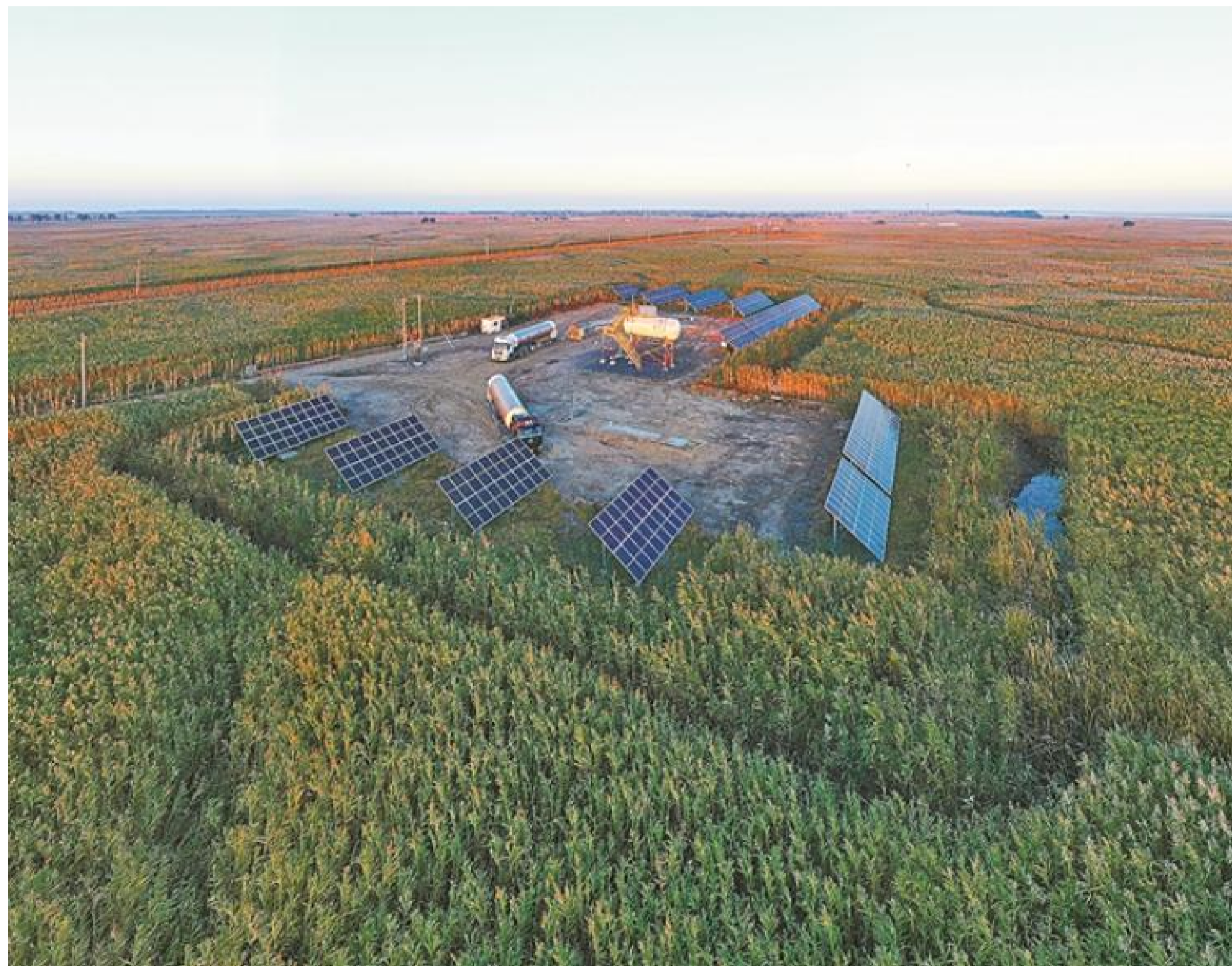
罐车运送液态二氧化碳驶入双229块二氧化碳试注现场。
