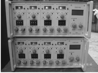
图1 SDY2107A 型超动态电阻应变仪
