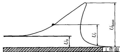
图 1 工作面前方弹性能的变化
