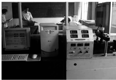
图 1 DRS-1 型高压直剪试验系统
