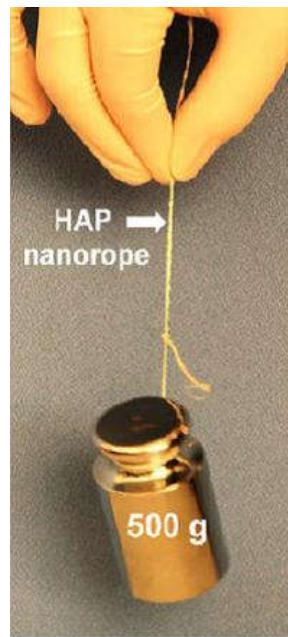
图3. 所制备的羟基磷灰石超长纳米线有序结构柔性耐火纳米绳具有良好的力学性能，可以承受较大重物
