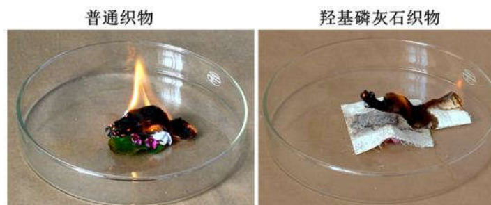
图5. 普通织物（左）和羟基磷灰石超长纳米线柔性耐火织物（右，中间层）的阻燃效果。普通织物快速燃烧殃及下层鲜花；而羟基磷灰石超长纳米线柔性耐火织物不燃烧且阻燃，并具有良好的隔热性能，可以很好地保护下层鲜花。
