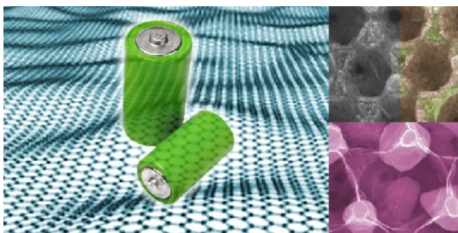
图 石墨烯结构示意图（左）和三维石墨烯基锂电池正极材料SEM照片（右）
