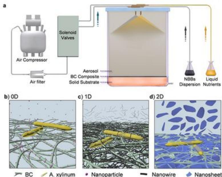
图1: 固态培养基-气溶胶生物合成法示意图。(a) 自动发酵反应器示意图，空气压缩泵中的高压气体通过自动控制系统控制，到达反应器顶端雾化喷头后，将液体培养基与纳米单元分散液雾化为连续气溶胶，原位实时沉积到纳米纤维素合成界面。(b-d) 纳米纤维素与零维(b)、一维(c)、二维(d)纳米材料原位同步复合示意图。
