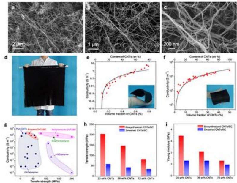
图2: 碳纳米管/细菌纤维素复合材料形貌及性能。(a-c) 碳纳米管/细菌纤维素复合材料扫描电镜照片, 在不同尺度下, 碳纳米管与纳米纤维素均匀缠绕分布。(d) 复合材料的大规模制备 (800×800×0.8 mm<sup>3</sup>)。(e, f) 复合材料气凝胶 (e)、薄膜 (f) 的碳纳米管含量与电导率关系曲线, 插图为数码照片。(g) 复合材料薄膜与文献报道的同类材料强度与电导率对比。(h, i) 生物合成法制备的复合材料薄膜与浆料法样品的强度与模量对比。
