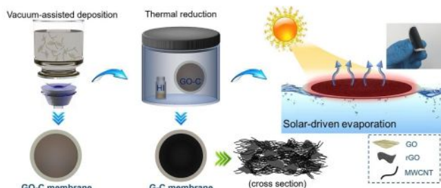
图1. 基于二维石墨烯与一维碳纳米管的纳米复合光热膜制备示意图
