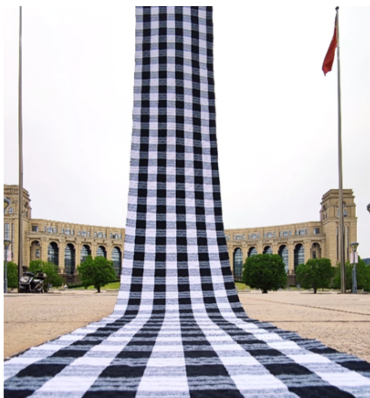
由纤维电池编织而成的大面积储能织物
