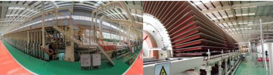
丰林连续压机生产线(全景图)
