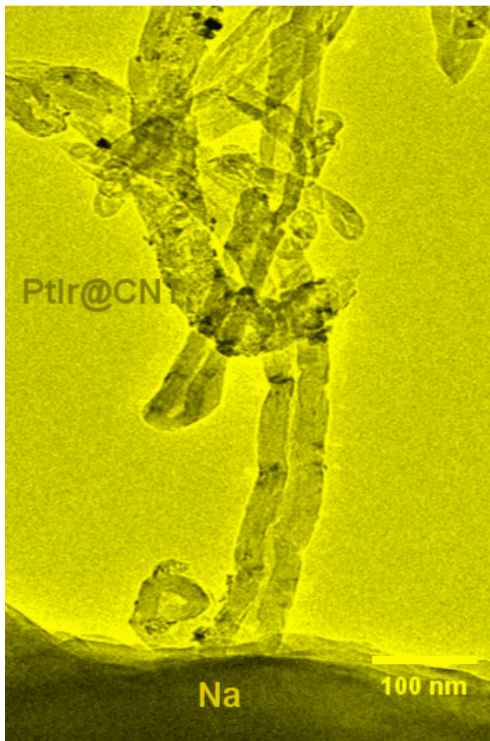
图3 环境电镜中钠-氧气纳米电池充放电循环过程的原位观测
