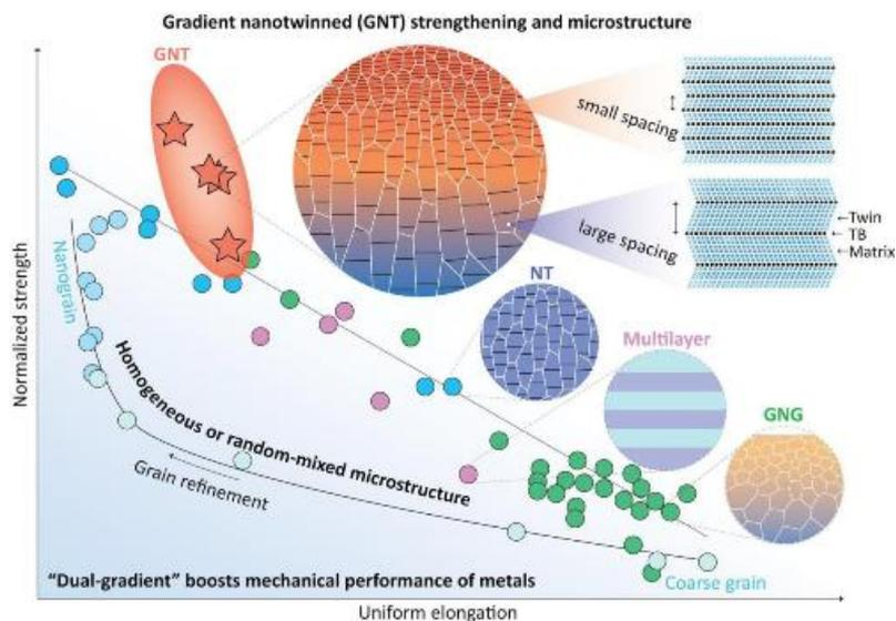
图1 梯度纳米孪晶结构引起金属材料的额外强化和塑性。梯度纳米孪晶结构 (GNT) 具有孪晶片层厚度和晶粒尺寸的空间梯度结构。该材料表现出了良好的强-塑性协同, 其屈服强度甚至超过了梯度微观结构中最强的部
