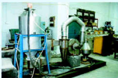
图 1 液雾燃烧制备纳米粉体装置
