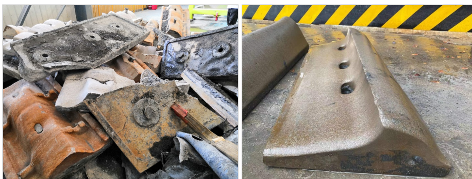
图2 原铸成型高锰钢衬板应用3个月和现用贝氏体锻成型应用5个月过后,拆除下来的衬板对比
