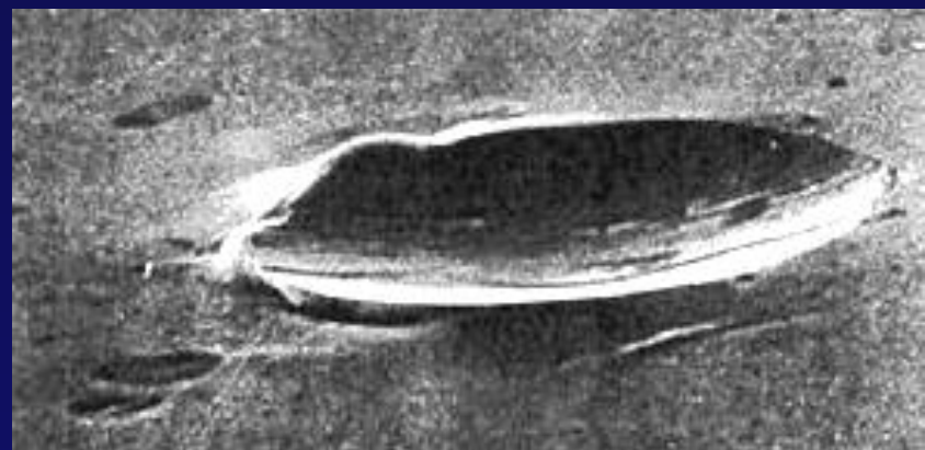
(b) 月牙形冲蚀形态
