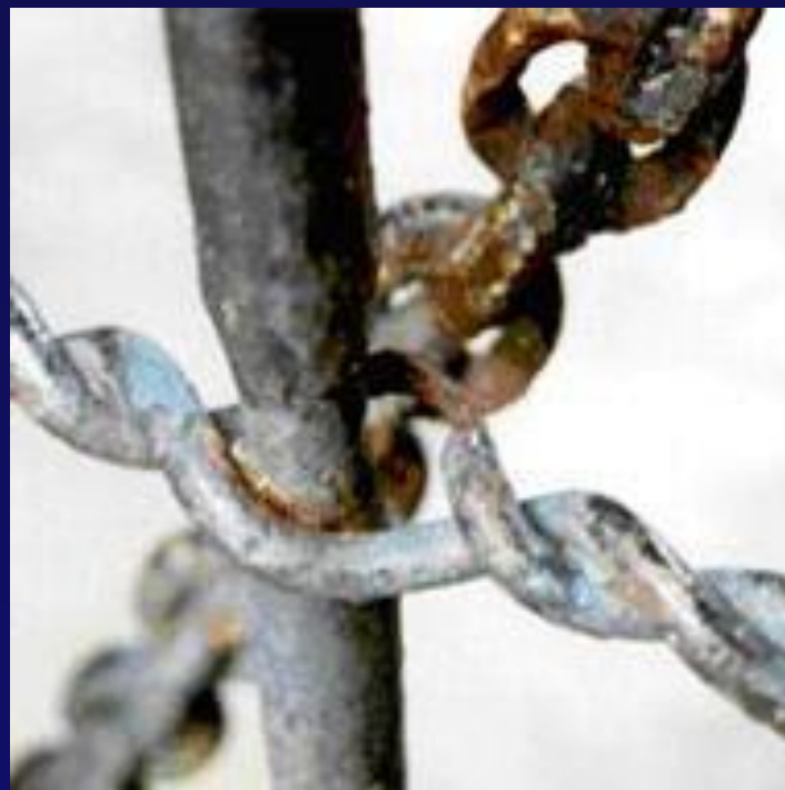
(b) 固定链条的微动磨损
