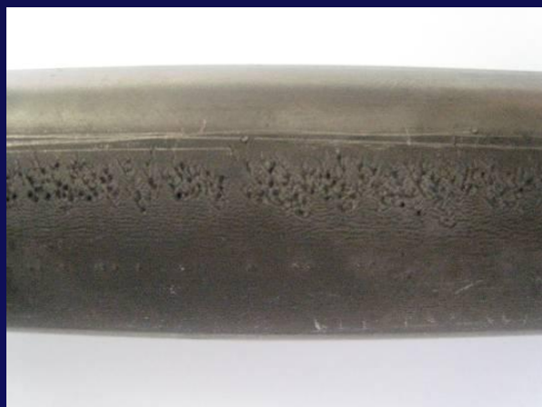
(a) 冲蚀宏观形貌
