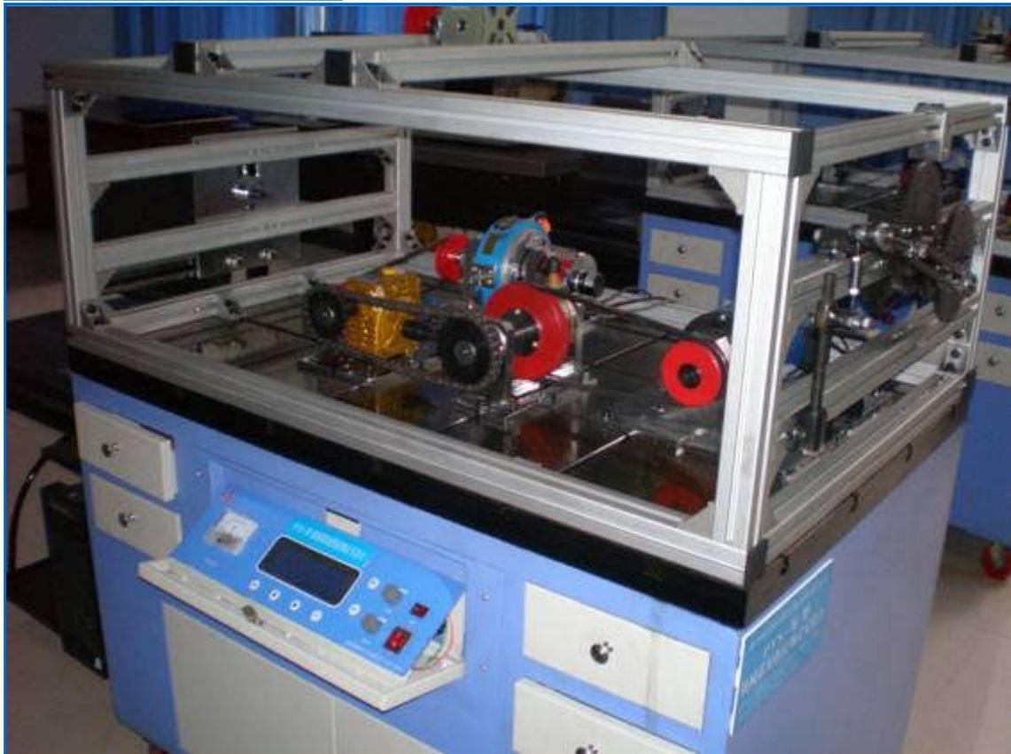
PYS-III型机械系统搭接测试实验台
